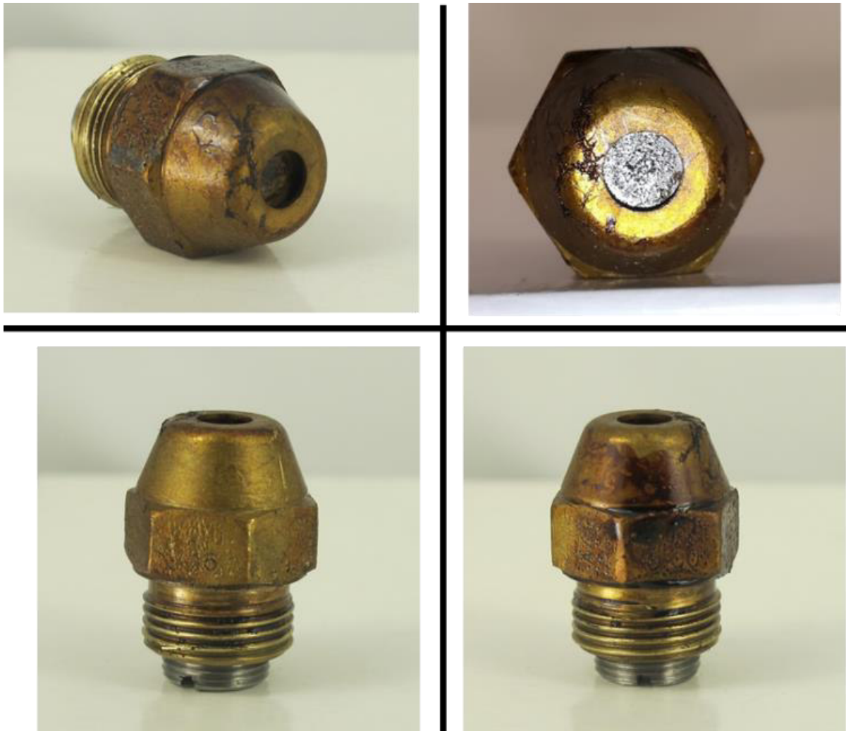
Abbildung 54: Die Düse nach der Nutzung im Reformer, mit Ablagerungsbildung auf dem Düsengehäuse, (oben links), auf der Düsenplatte (oben rechts). Die Ablagerungen am Düsengehäuse entstehen durch Tropfenbildung und Abfließen am Düsengehäuse. Deutlich zu erkennen ist der Unterschied zwischen dem im Reformer nach oben zeigenden Teil des Düsengehäuses (unten links) und dem nach unten ausgerichteten Teil des Düsengehäuses (unten rechts). Der nach unten ausgerichtete Teil des Düsengehäuses zeigt aufgrund der nach unten laufenden Tropfen eine deutlich höhere Ablagerungsbildung.
