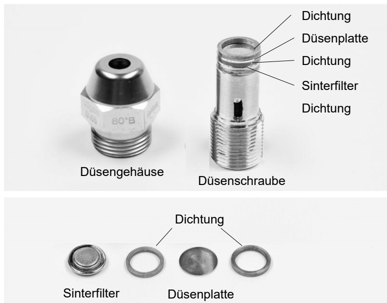
Abbildung 15: Fotoaufnahme vom Düsengehäuse und den Düseneinbauten.
