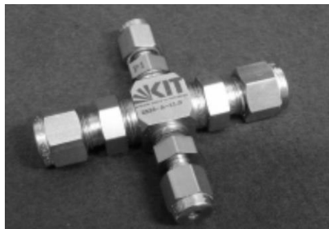
Abbildung 18: Fotoaufnahme vom Mikrowärmeübertrager (Leihgabe vom KIT).
