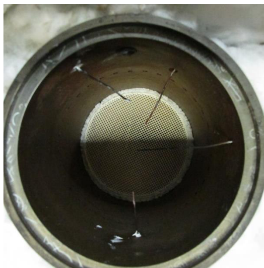
Abbildung 47: Reformer mit eingesetztem Katalysator, die Thermoelemente im Gemischbildungsbereich sind zu erkennen.
