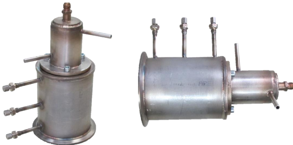
Abbildung 44: Die Reaktorverlängerung vergrößert den Gemischbildungsbereich und dient der Implementierung der ZBT-Düse.
