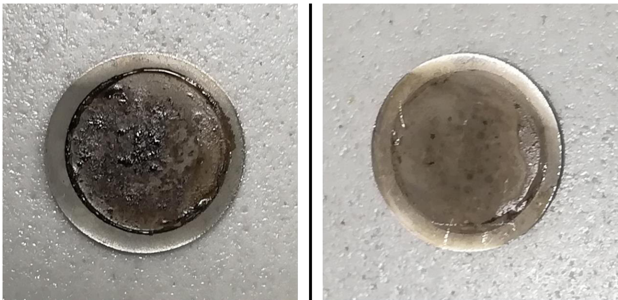
Abbildung 53: Bilder der Düsenplatte vor der Reinigung im Ultraschallbad (links) und danach (rechts). Die Düsenplatte ist auch nach Reinigung nicht mehr vollständig funktionsfähig. Vereinzelt Düsenbohrungen konnten von Ablagerungen gereinigt werden.
